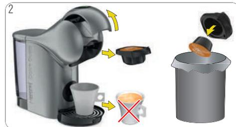
2 No beba el café. Abra la manija de bloqueo. La máquina libera presión. Retire el soporte de la cápsula. Tire la cápsula usada en el contenedor de residuos.
