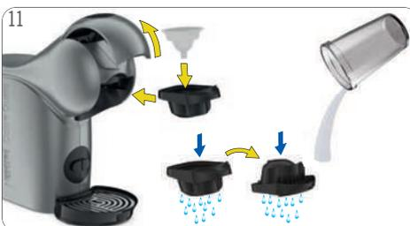
Retire el depósito. Vacíe y limpie el depósito. Retire el soporte de la cápsula. Retire la herramienta de enjuague. Guárdelo en un lugar seguro para su posterior limpieza o descalcificación. Enjuague ambos lados del soporte de la cápsula con agua potable fresca. Vuelva a insertar el soporte de la cápsula.
