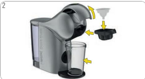
2 Abra la manija de bloqueo. Ponga la herramienta de enjuague dentro del soporte de la cápsula. Inserte el soporte de la cápsula en la máquina. Coloque un depósito grande vacío debajo de la salida de café.
