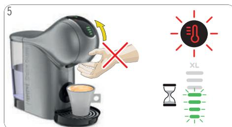
5 Después de terminar la preparación, el icono de selección de temperatura y la luz del display de barras parpadean durante un máximo de 8 segundos. **¡No abra la manija de bloqueo durante este intervalo!**
