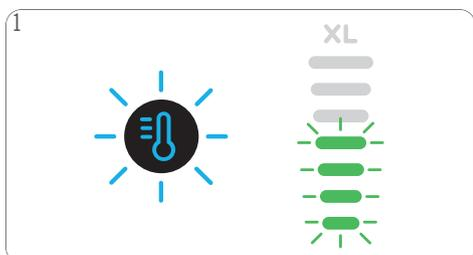
1 **Opción C:** Se ha preparado una bebida caliente o no se ha seleccionado el modo frío en los 10 segundos posteriores al inicio de la máquina. Toque el icono de selección de temperatura para pasar al modo frío. El icono de selección de temperatura parpadeará en azul para indicar que la máquina necesita enfriarse.
