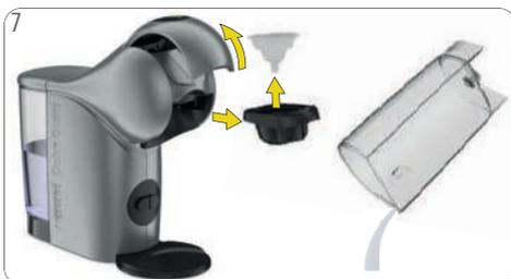
Abra la manija de bloqueo. Retire el soporte de la cápsula. Retire la herramienta de enjuague. Guárdelo en un lugar seguro para su posterior limpieza o descalcificación. Vacíe el agua que pudiera haber en el depósito de agua.
