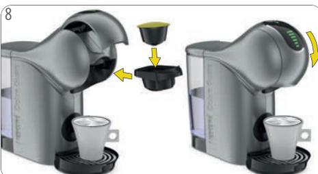
8 Inserte la segunda cápsula en el soporte de la cápsula. Insértelo de nuevo en la máquina. Cierre la manija de bloqueo.
