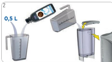
2 Vacíe el agua que pudiera haber en el depósito de agua. Mezcle 0,5 litros de agua potable fresca con un descalcificador en un recipiente de medición. Vierta la solución de descalcificación en el depósito de agua e inserte el depósito de agua en la máquina.
