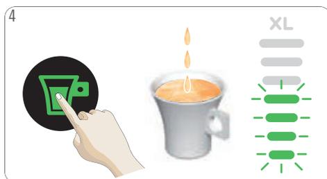
4 Toque el icono de inicio/parada. Se inicia la preparación de la bebida. **No abra la manija de bloqueo durante la extracción.** Espere hasta que la extracción finalice. La máquina detiene la preparación automáticamente. La extracción puede detenerse manualmente en cualquier momento pulsando el icono de inicio/parada.
