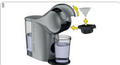
8 Abra la manija de bloqueo. Retire el soporte de la cápsula. Retire la herramienta de enjuague. Vuelva a insertar el soporte de la cápsula.
