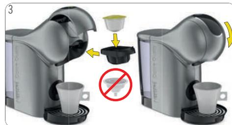
3 Asegúrese de que la herramienta de enjuague no esté dentro. Inserte la primera cápsula en el soporte de la cápsula. Insértelo de nuevo en la máquina. Cierre la manija de bloqueo.
