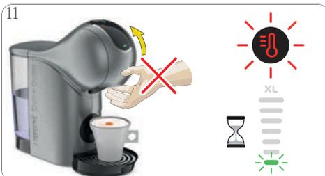
11 Después de terminar la preparación, el icono de selección de temperatura y la luz del display de barras parpadean durante un máximo de 8 segundos. **¡No abra la manija de bloqueo durante este intervalo!**
