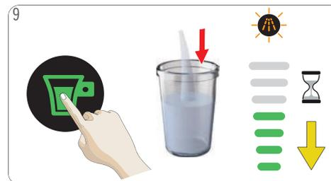
Toque el icono de inicio/parada. La máquina se enjuaga continuamente con agua caliente. Las luces del display de barras se apagan progresivamente. La máquina detiene el enjuague una vez que el depósito de agua está vacío.
