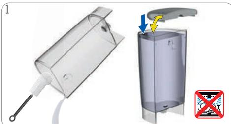
Enjuague y limpie el depósito de agua. Use un cepillo limpio seguro para alimentos y detergente líquido según sea necesario. A continuación, rellene el depósito de agua con agua potable fresca e insértelo en la máquina. El depósito de agua no es apto para lavavajillas.
