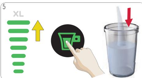
Ajuste el display de barras al nivel máximo con el selector de volumen táctil. Toque el icono de inicio/parada. Se inicia el enjuague de la máquina.
