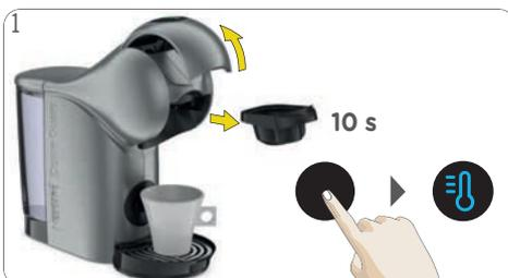
1 Abra la manija de bloqueo. La máquina se enciende automáticamente. Toque el icono de selección de temperatura en los 10 segundos posteriores al inicio de la máquina para cambiar al modo frío (azul). La bebida fría puede prepararse inmediatamente.
