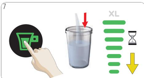
7 Toque el icono de inicio/parada. Se inicia el enjuague de la máquina. Espere hasta que la máquina se detenga automáticamente. El botón de selección de temperatura y la luz del display de volumen parpadean durante un máximo de 8 segundos.
